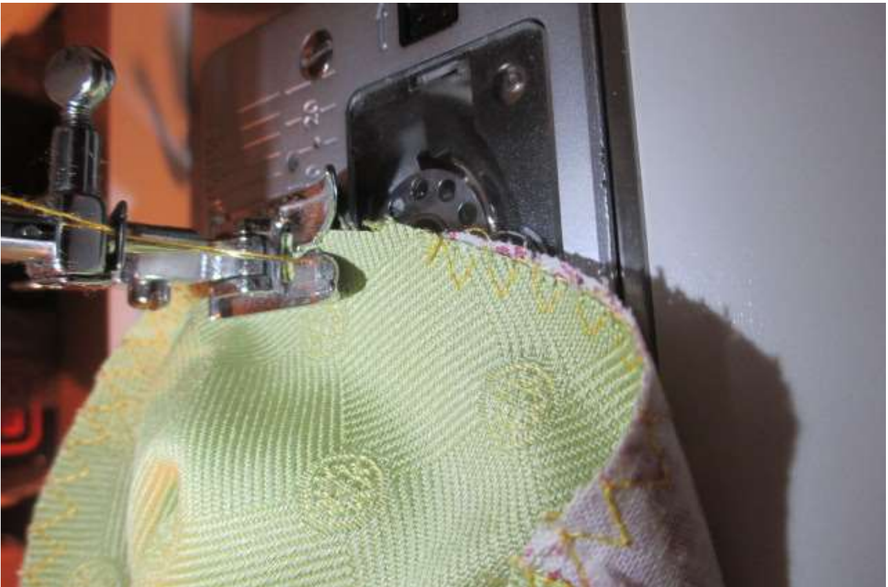
Die Kante vom Kegel versäubern mit Zickzackstich oder Overlock
